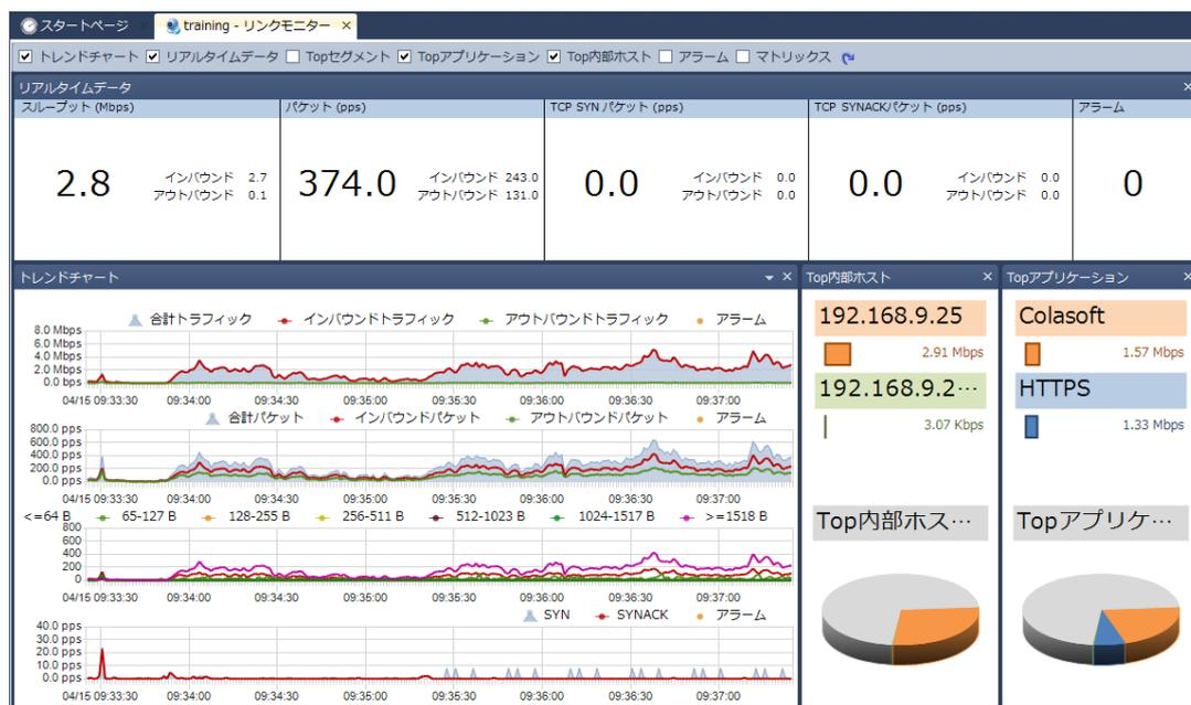
リンクモニターウィンドウは、トップバーといくつかのパネルからなっています。パネルには、リアルタイムデータパネル、トレンドチャートパネル、トップセグメントパネル、トッ
